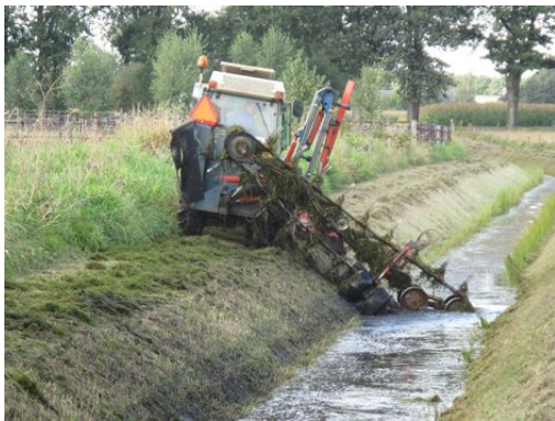
waterplanten worden mechanisch verwijderd uit de sloot
