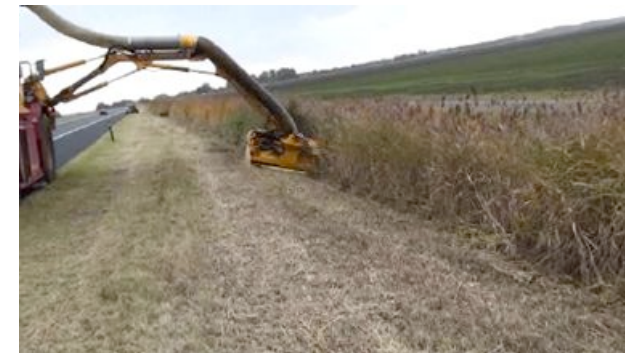
volautomatische maai-zuigcombinatie, dat maaisel ook verpulverd
