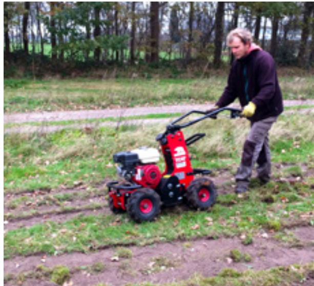
De zode afplaggen met een zodensnijder.
