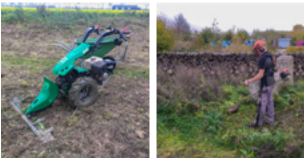
Messenbalk (links) en bosmaaier (rechts).
